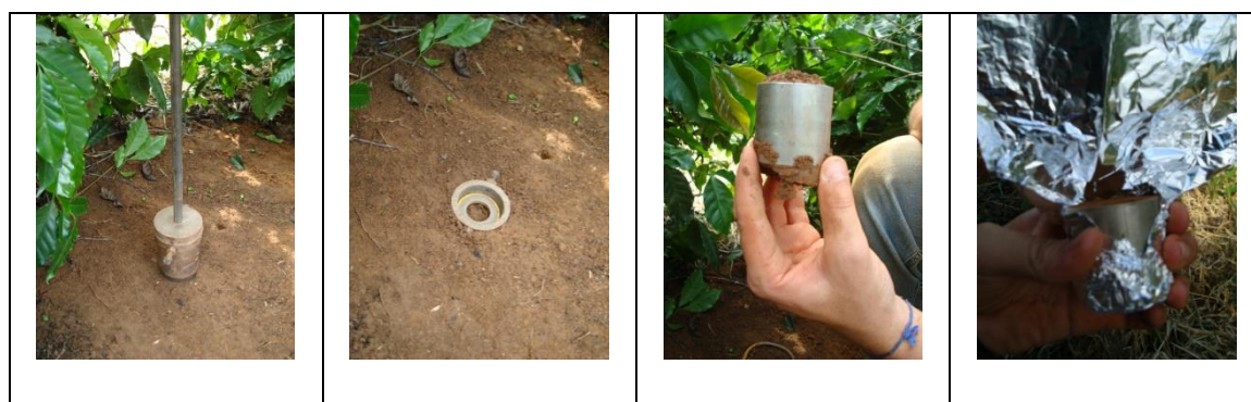
Figura 2: Coleta das amostras de solo para determinação da umidade gravimétrica, utilizando um amostrador de Uhland.
