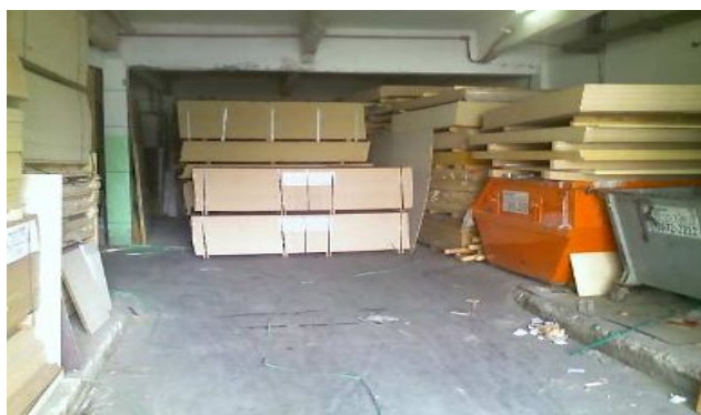
Figura 1. Empilhamento incorreto de painéis como matéria-prima. Setor de Seccionamento
